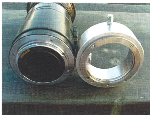
Abb. 3: Ein Blick in den Adapterring zur Lasche, welche die Blende während der Montage öffnet.
